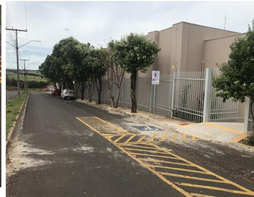
Fotos 33 e 34 – Acessibilidade na área externa – demarcação dos obstáculos e do estacionamento para idosos e portadores de necessidades especiais
